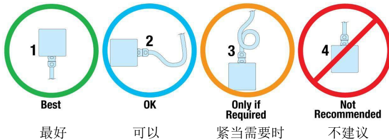
图 5.1：推荐的 ServoWeld 布线路由。
